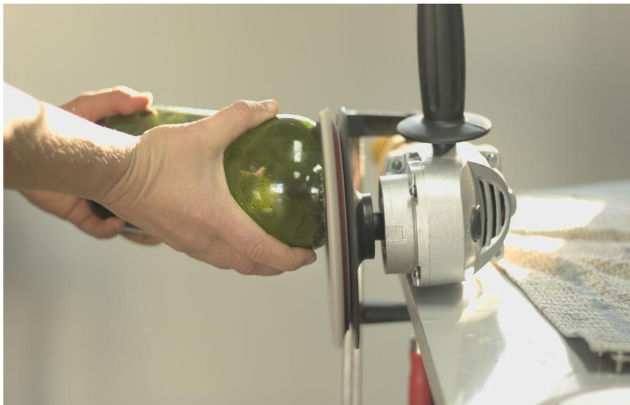
*Figura 14. Corte oblicuo de una botella, en proceso de pulido/Corte oblíquo de uma garrafa, em processo de polimento*
