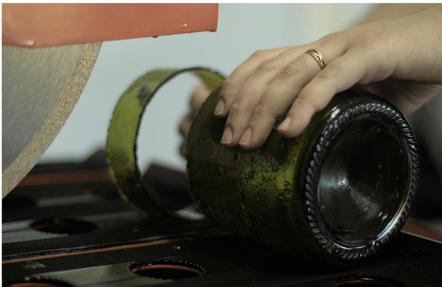
*Figura 12. Proceso de pulido manual de un corte oblicuo/Processo de polimento manual de um corte oblíquo*
