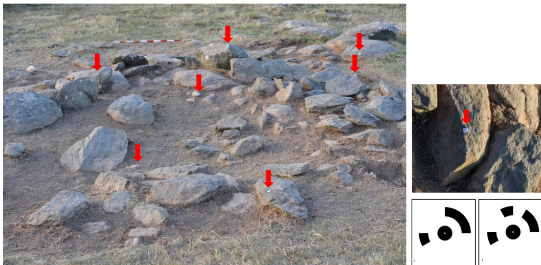
Figura 5. Escena de registro fotogramétrico de la estructura. Izquierda: posición de la escala y el detalle de las dianas distribuidas sobre la estructura (indicadas con flecha roja). Derecha: detalle de posición y aspecto de las dianas utilizadas en el levantamiento topográfico. Fuente: archivo LAPPU.
