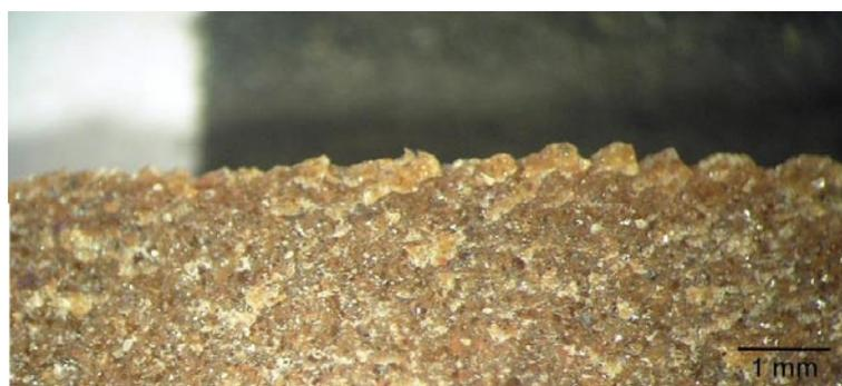
*Ilustración 6: Bisel activo de instrumento CA1, luego de 20 minutos de experimentación, a 20x.*
