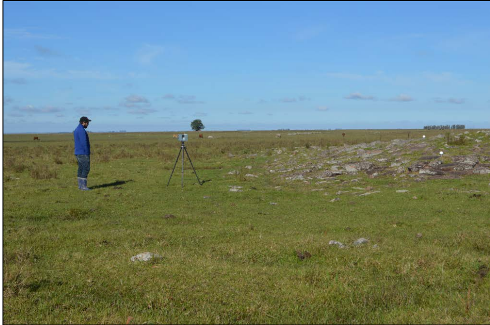
Figura 10. Escáner Trimble TX5, Ing. Yelicich realizando el registro perimetral del afloramiento con grabados.
