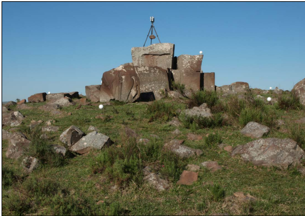
Figura 11. Escáner situado en posición central del afloramiento para una cobertura 360°.
