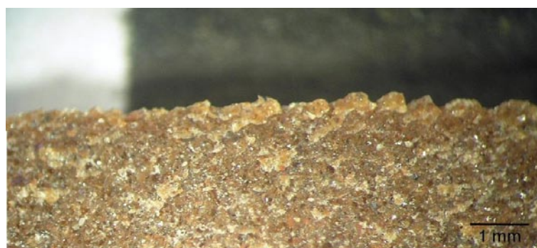
Ilustración 6: Bisel activo de instrumento CA1, luego de 20 minutos de experimentación, a 20x.
